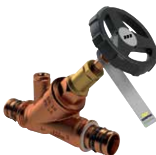
WESER Freistrom-Absperrventil, mit Entleerstopfen, MEPLA, Figur 190 40
