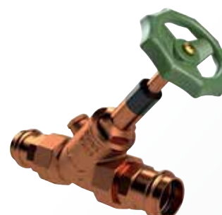
ECO Freistrom-Absperrventil, mit Entleerstopfen, mit fest inte- griertem Pressanschluss auf SANPRESS/ PROFIPRESS, Figur 171 30
