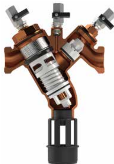
Obr. 5 Zobrazení v řezu oddělovače systému typ BA
