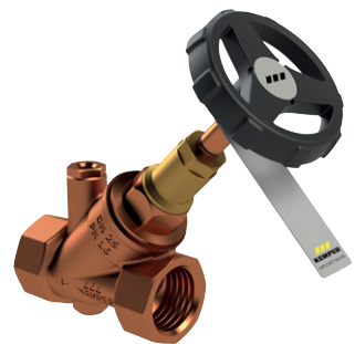
WESER Freistrom-Absperrventil, mit Entleerstopfen, IG, Figur 190 02
