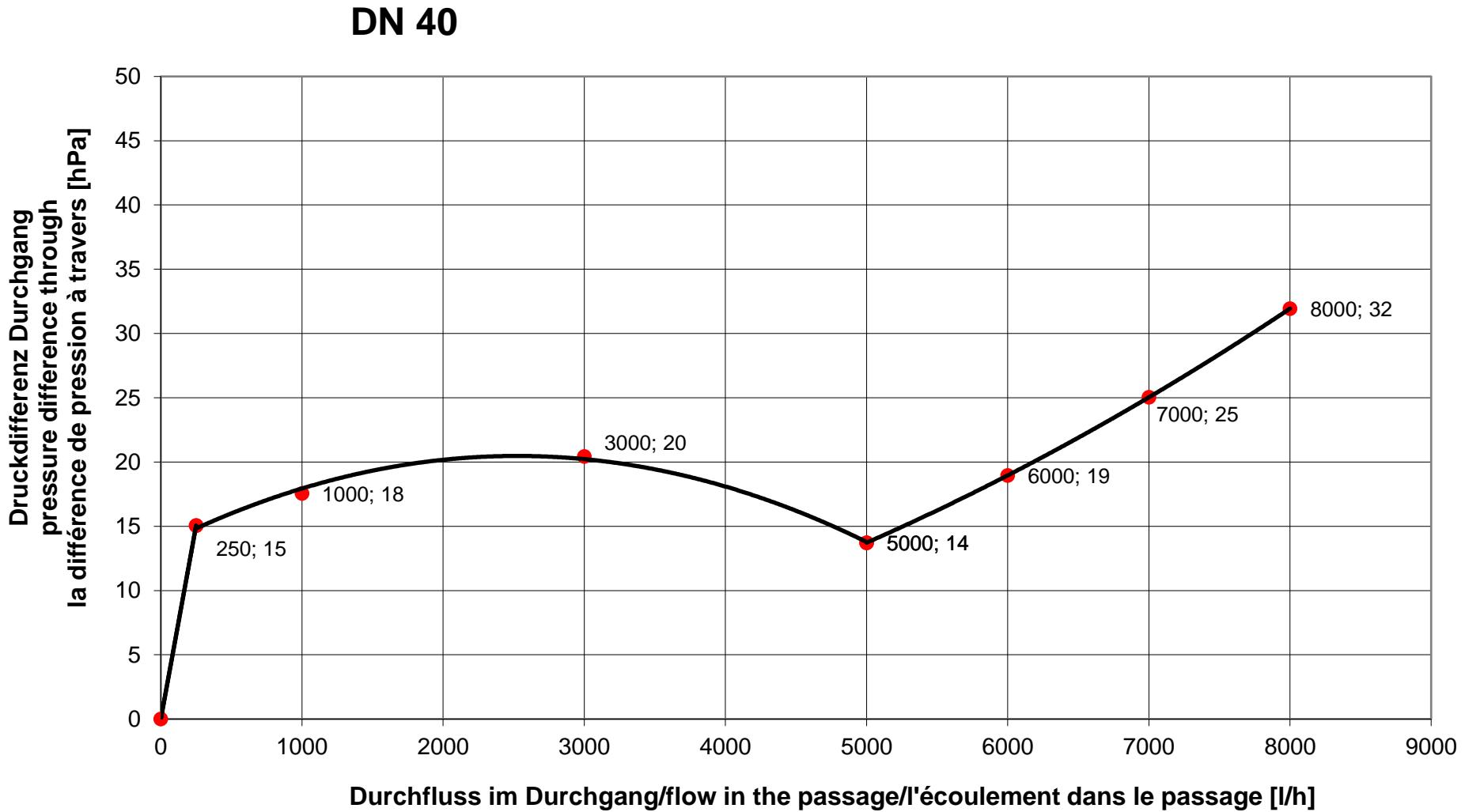
Durchflussdiagramm/Flow Diagram/Diagramme de débit
