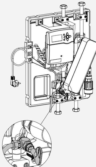
Dimensionieren Sie den Abwasseranschluss nach DIN EN 12056 und DIN 1986-100 ausreichend groß. Nehmen Sie den Volumenstrom an, der durch die Anschlussleitung an der Spülgruppe anstehen kann. Dieser beträgt nach der Werkskonfiguration 10 l/min.
