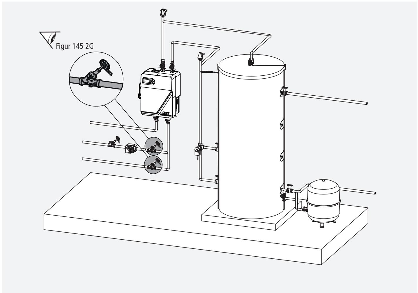
Zur Vermeidung von wärmeausdehnungsbedingten Druckschwankungen wurde herstellereitig ein fest verbautes Sicherheitsventil in der Station vorgesehen. Führen Sie den Abwasseranschluss nach den a.a.R.d.T. durch.
