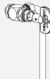
**5.6****4 x VAV Vollstrom-Absperrventil DN 20,
