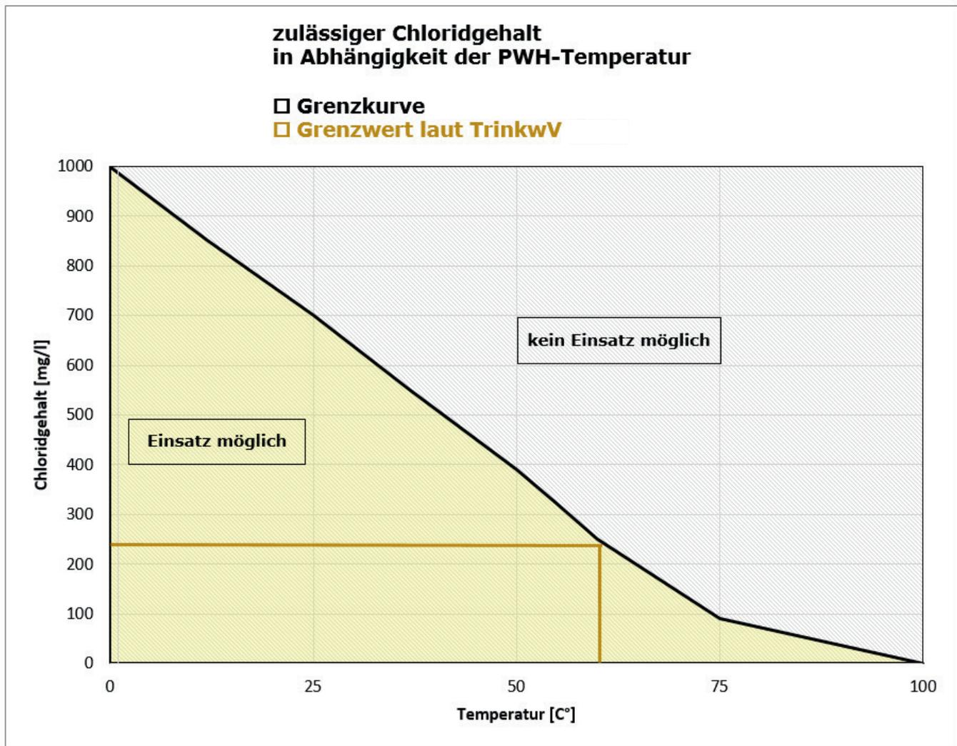
Zulässiger Chloridgehalt in Abhängigkeit von der Temperatur für den Werkstoff 1.4404 / SA240 316L des Plattenwärmeübertragers
