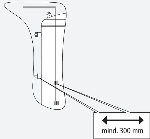
Beispielhaft aufgeführt finden Sie in der nachfolgenden Abbildung und Tabelle Standard-Fühlerhöhen im Verhältnis zur installierten Tankgröße. Bitte beachten Sie, dass die unten aufgeführten Fühlerhöhen lediglich in Kombination eines KEMPER ThermoTanks ihre Gültigkeit haben, da diese mit den jeweiligen Wärmekapazitäten,
