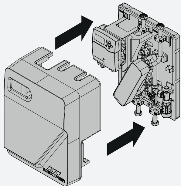
Die Frischwasserstation PRO S kann optional zur Wandbefestigung direkt an dem KTS ThermoTank angeschraubt werden.
