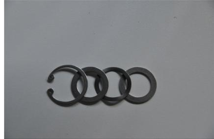
Bild 18 - Reihenfolge der Ringe von vorne nach hinten
