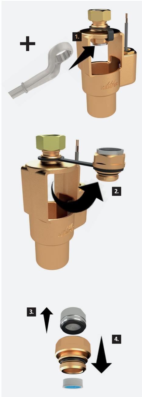
**1.** Dévissez la partie à visser en bronze avec le limiteur de débit en utilisant une clé polygonale de 27.
