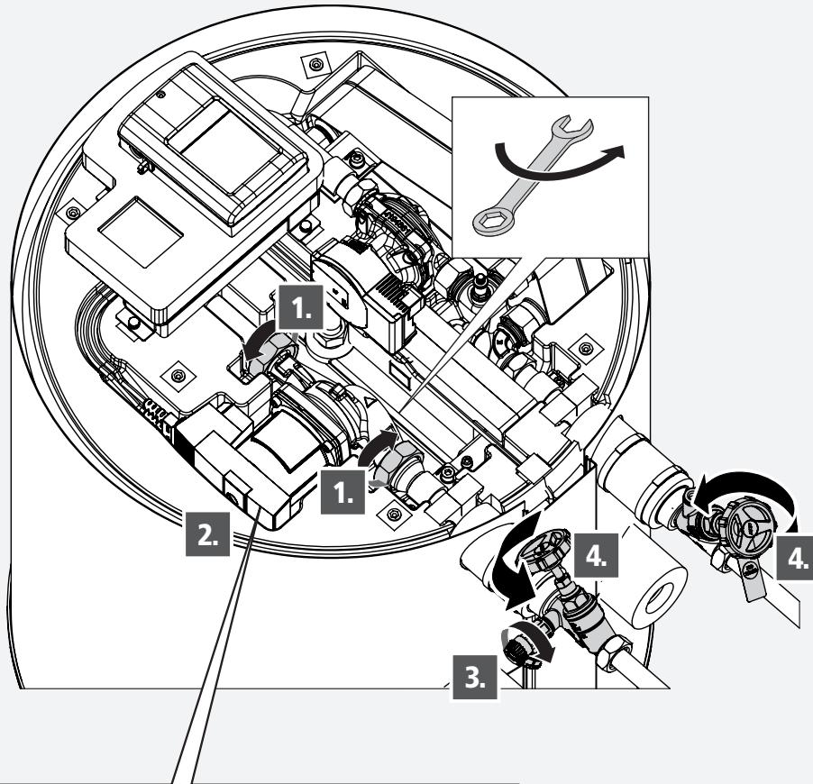
**DE** Vorhandene Restfeuchtigkeit an den beiden Verschraubungen mittels Lappen entfernen
