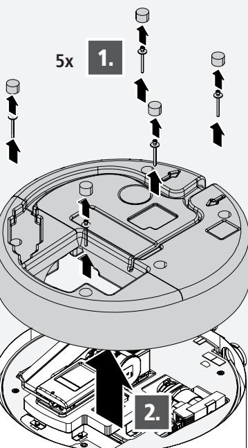
**DE** **Info!** Die Haube kann nur abgenommen werden, wenn zuvor der Stecker gelöst wurde. Dadurch können keine Arbeiten an den Bauteilen unter Spannung vorgenommen werden. Der Kaltwasserkühler ist so von der Energiequelle getrennt und gegen Wiedereinschalten gesichert.
