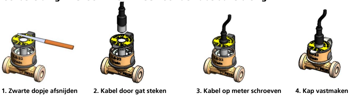
Afb. 6.12: Schematische weergave van de voorbereiding van het sensorbovenstuk voor het creëren van de kabelstekker van de KHS-CONTROL-PLUS
