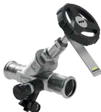
Stopkraan van rvs, met aftapper, met vast geïntegreerde MAPRESS-persaansluiting, figuur 073 01
