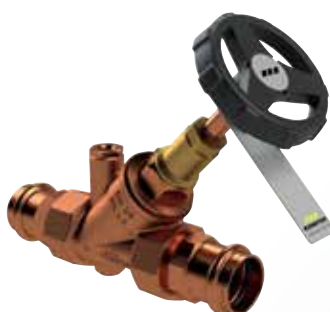
WESER stopkraan, met aftapstop, met vast geïntegreerde SANPRESS/PROFI-PRESS-persaansluiting, figuur 190 30
