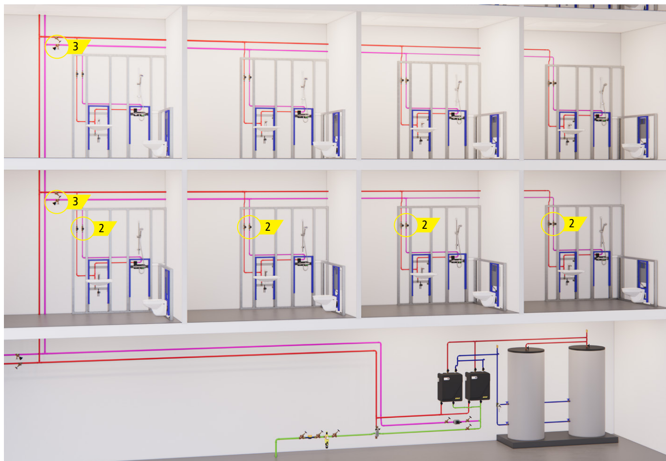
Principeopbouw van een circulatiesysteem met circulatie tot aan de tappunten met een tweetraps inregeling
