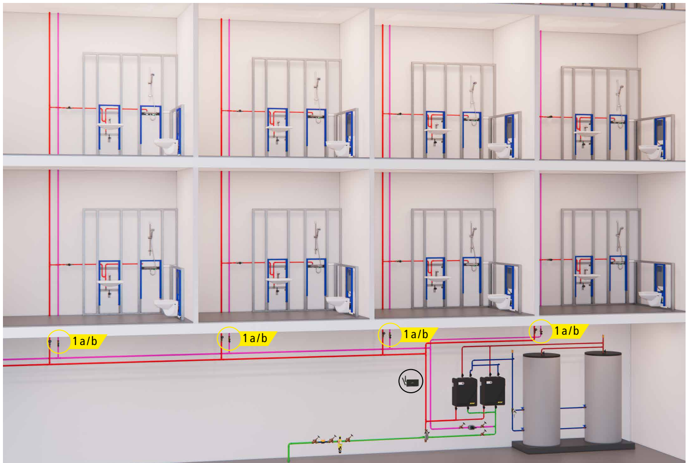
Prinzipieller Aufbau eines Zirkulationssystems mit einer Zirkulation im Steigstrang
