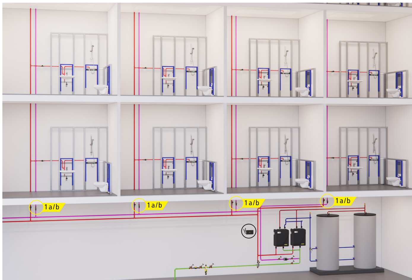
Skematisk diagram over et cirkulationssystem med cirkulation i stigestreng
